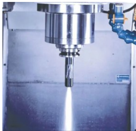
CTS Refrigerante a través de la herramienta 20 bar | 70 bar
